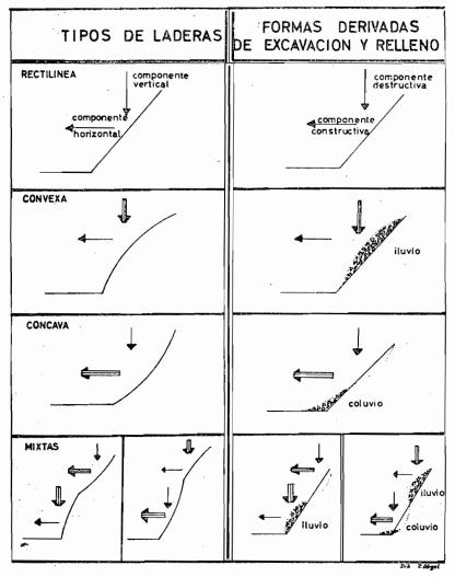
son rápidamente evacuados del lugar original, transportados y depositados al pie de la ladera, la que, se modela con un perfil cóncavo. En este caso, los materiales depositados se llaman coluvios.
