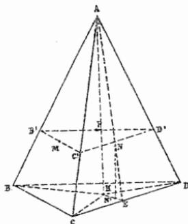
será proporcional al área del triángulo  $HCD$  i su línea de acción encontrará  $BCD$  en el punto  $N'$  proyección de  $N$ ; este punto  $N'$  es precisamente el centro de gravedad del triángulo  $HCD$ ; 2.º la componente  $F_2$  será proporcional al área de un triángulo de base  $CD$  i de altura  $AH$ .
