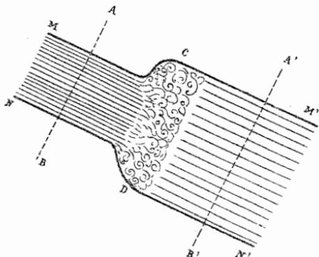
se ensancha bruscamente, el líquido forma remolinos i que, ántes i despues de esa rejion, las moléculas líquidas se mueven paralelamente con una velocidad sensiblemente constante.
